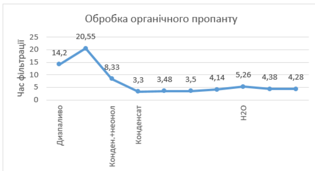
Рис. 1. Застосування обробленого органічного пропанту розчином неонолу
