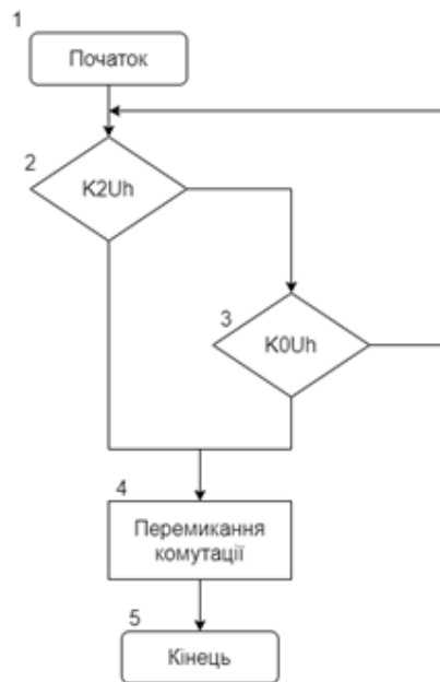
Рис. 2. Блок-схема алгоритму регулювання коефіцієнта несиметрії напруги за зворотною і нульовою послідовністю при високому відсотку несиметрії
