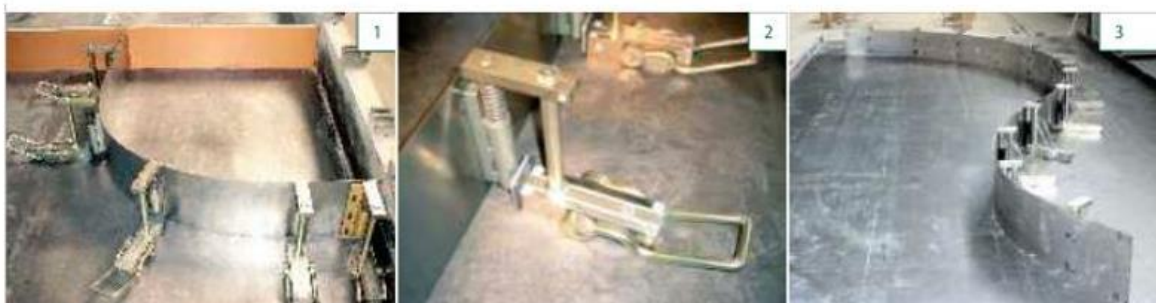
Рис. 3. Застосування опалубної системи MagFlex®
