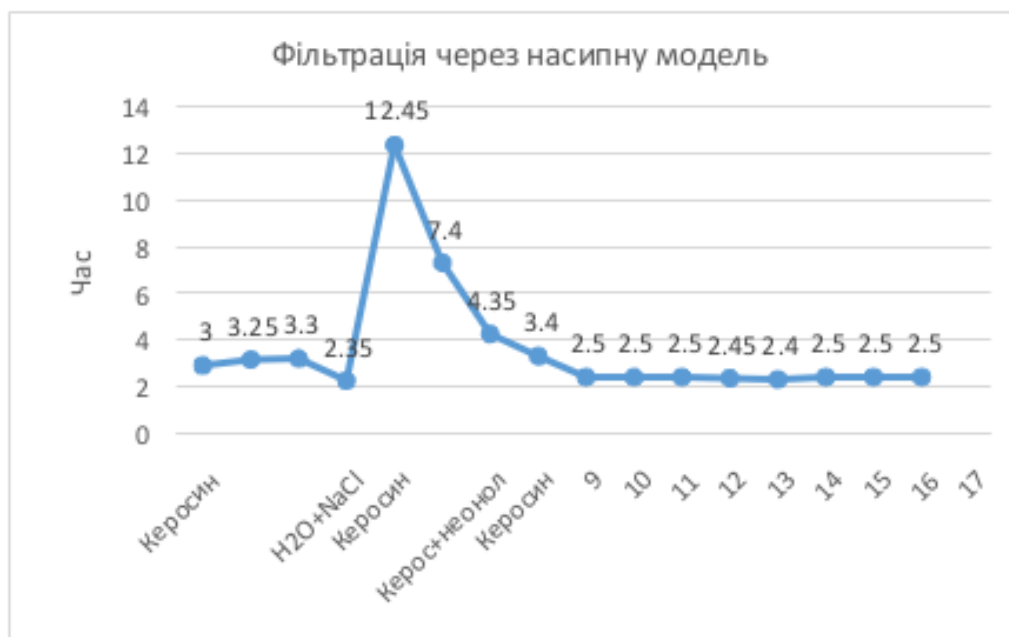
Рис. 2. Зміна часу фільтрації при наявності у насипній моделі мінералізованої води
