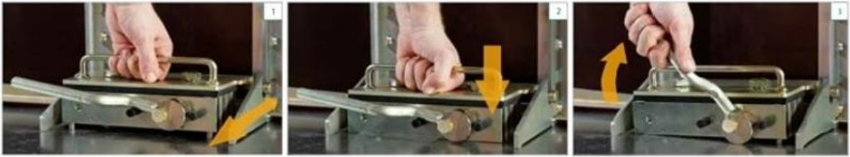
Рис. 1. Принцип дії універсального магніту MagFly®
