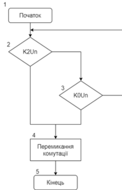
Рис. 1. Блок-схема алгоритму регулювання коефіцієнта несиметрії напруги за зворотною і нульовою послідовністю при нормальному відсотку несиметрії
